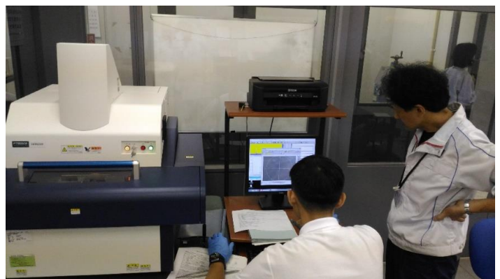
圖 1 操作 XRF 量測設備(本圖片經荏原製作所同意拍攝，請勿轉貼)
